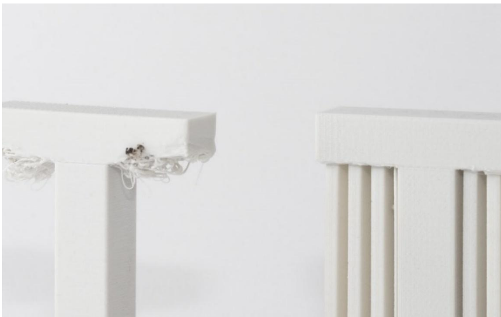
Figure 11. Lettre T imprimée sans et avec support (Source:
