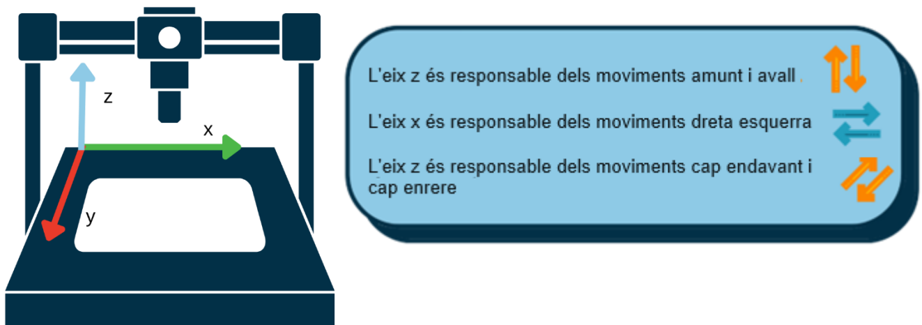
Figura 2. Eixos x, y i z en una impressora 3D
